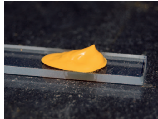
Die Nanopartikel in der Farbe machen aus dem Untergrund eine Solarzelle.
